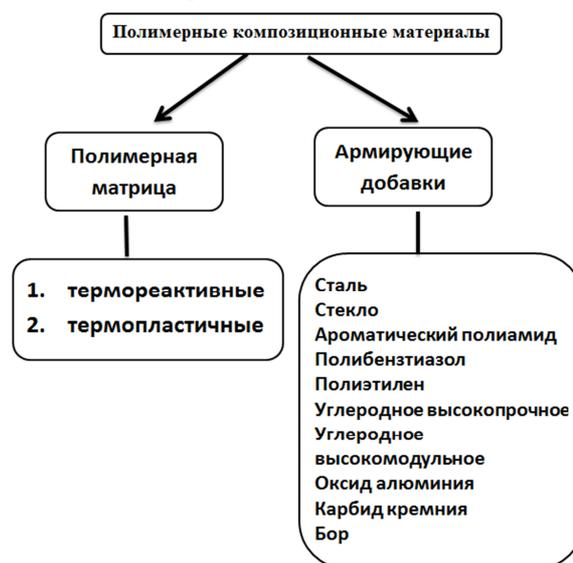
Рис. 2. Структура полимерного композиционного материала
