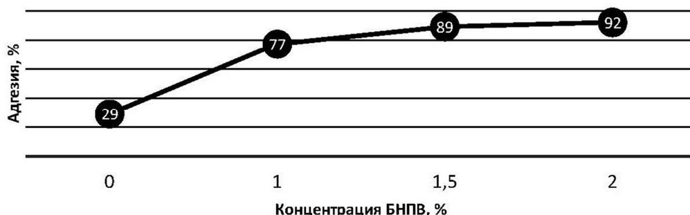
Рис. Влияние добавки БНПВ на величину адгезии битума БНД 100/130 к поверхности гранитного щебня
