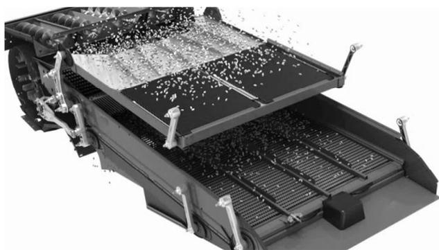
Рис. 1. Решетный стан комбайна «Нива»
