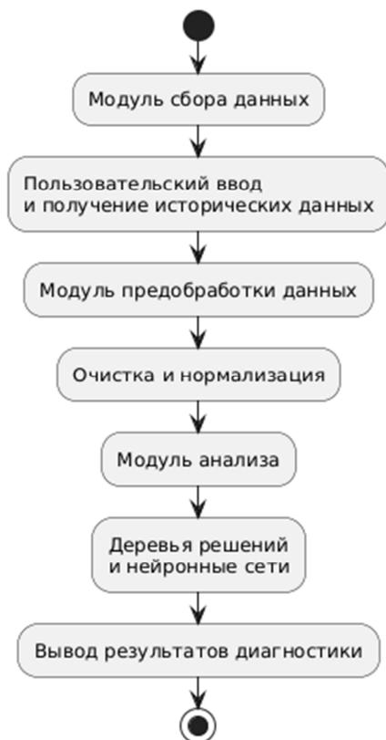
Рис. 1. Блок-схема архитектуры ИИ-модуля диагностики
