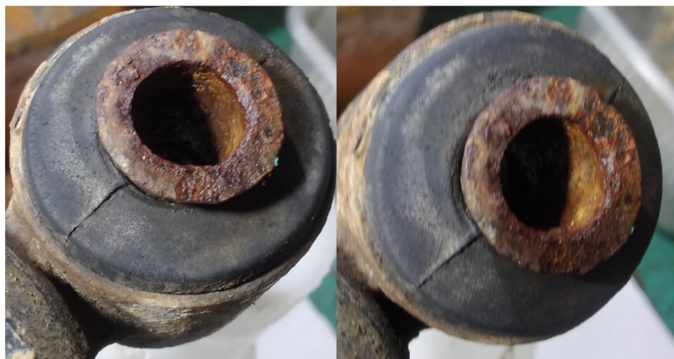
Рис. 3. Старение упругой втулки нижнего крепления амортизатора, приведшее к отрыву эластомера от металла втулки (10 лет и 142 тыс. км пробега)
