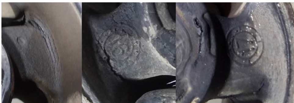
Рис. 2. Усталостные разрушения опоры рычага подвески (6 лет и 84 тыс. км пробега)
