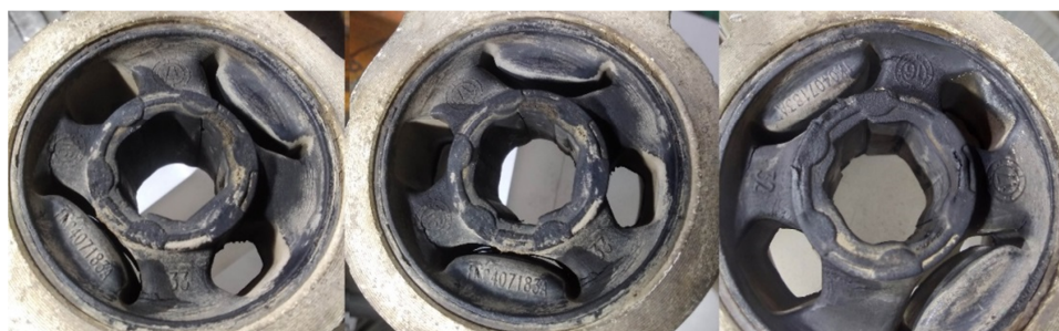
Рис. 1. Примеры повреждений упругих опор рычага подвески легкового автомобиля
