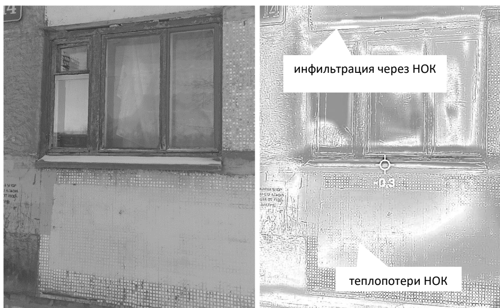
Рис. 4. Фотография одного из окон здания и его термограмма
