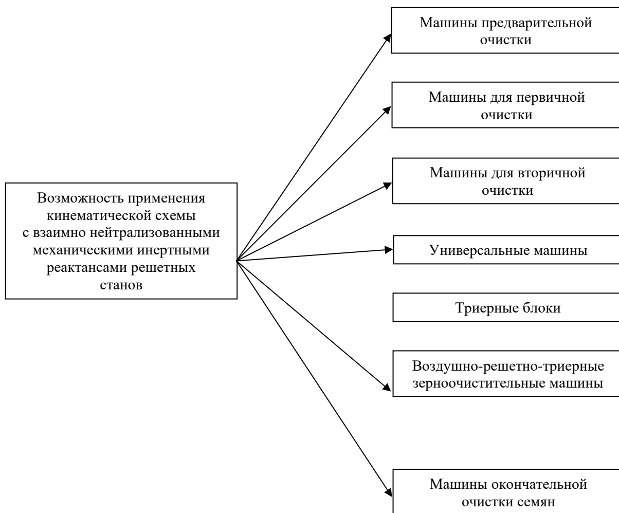
Рис. 2. Классификация зерноочистительных машин с учетом возможности применения кинематической схемы с взаимно нейтрализованными механическими инертными реактансами решетных станов
