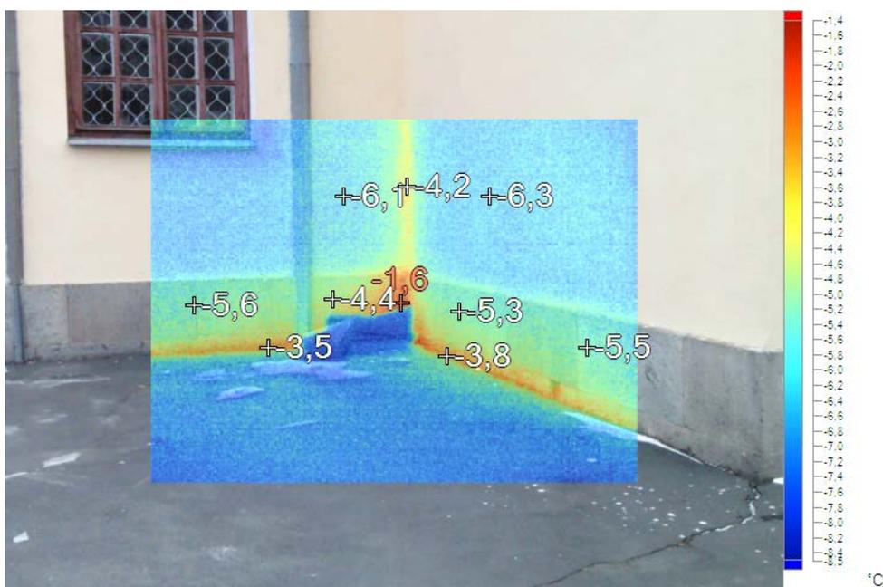
Рис. 2. Локальные зоны утечки тепла из подвального помещения
