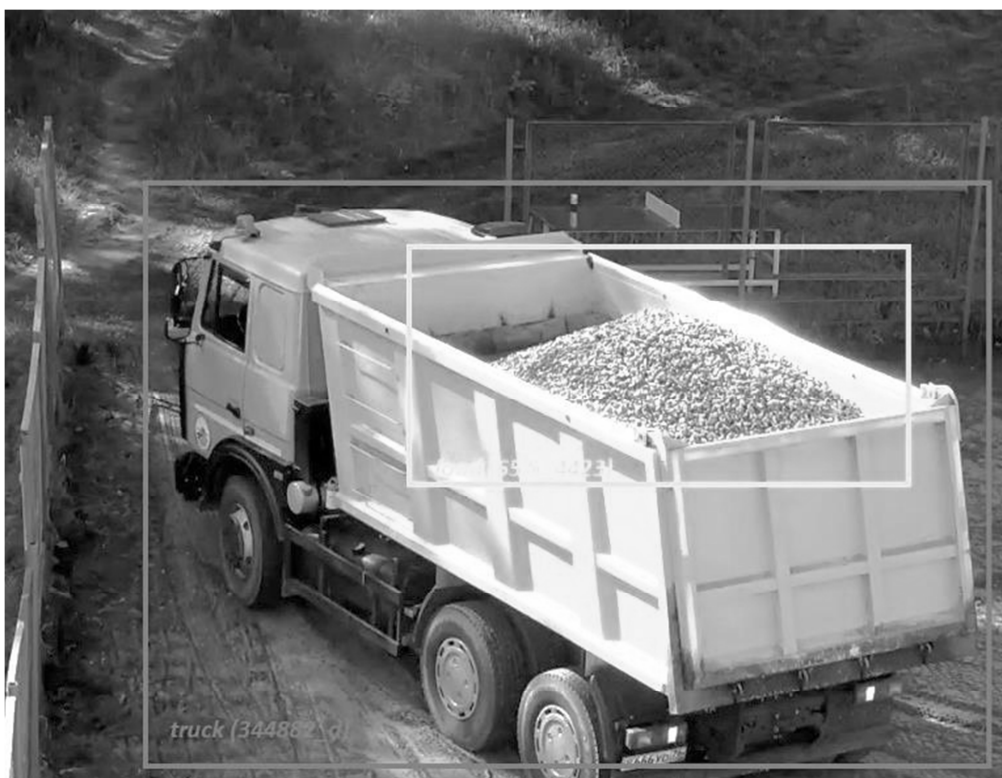
Рис. 5. Пример работы машинного зрения при определении степени и параметров загрузки открытого самосвального кузова
