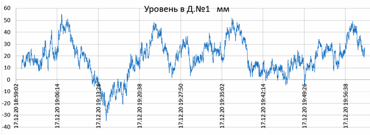
Рис. 2. Отклонение уровня воды в деаэрационном баке
