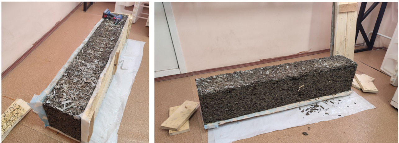
Рис. 2. Общий вид изготовленной балки из армированного арболита
