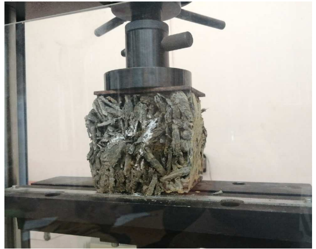
Рис. 1. Общий вид контрольных образцов: а) до приложения нагрузки; б) после достижения предельной нагрузки
