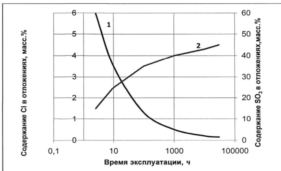
Рис. 2. Зависимость изменения хлора и серы в отложениях: 1 – Cl; 2 – SO_3
