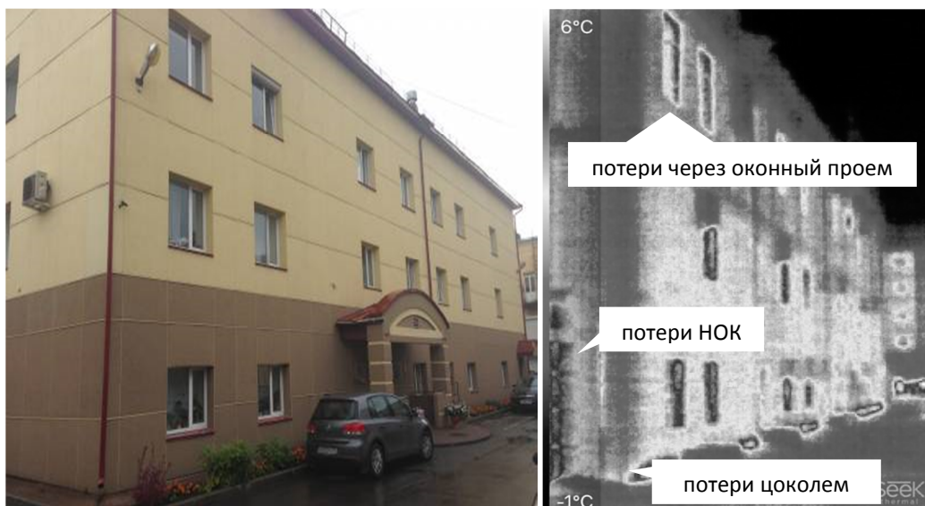
Рис. 2. Фотография наружной стены здания и ее термограмма
