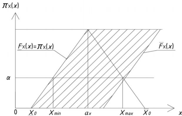
Рис. 2. Граничные функции распределения  $F_X(x)$  и  $\bar{F}_X(x)$
