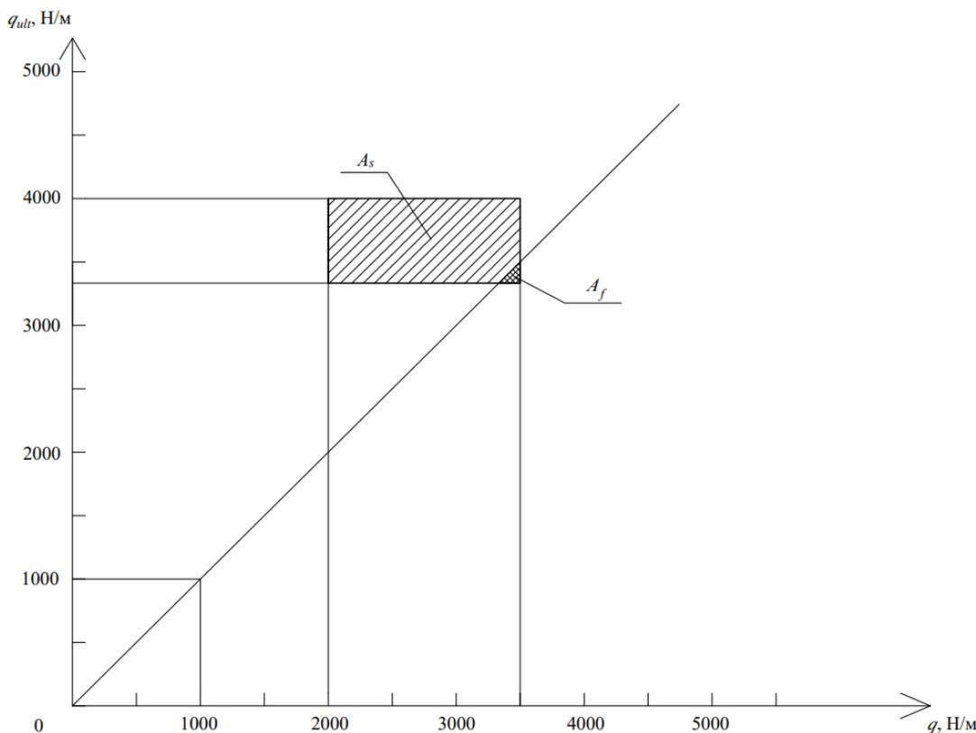
Рис. 4. Графический способ определения вероятности безотказной работы
