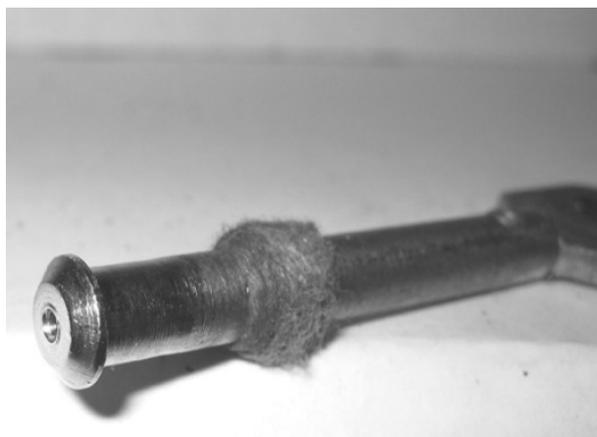
Рис. 4. Шип типа 8-10-1, установленный на шток
