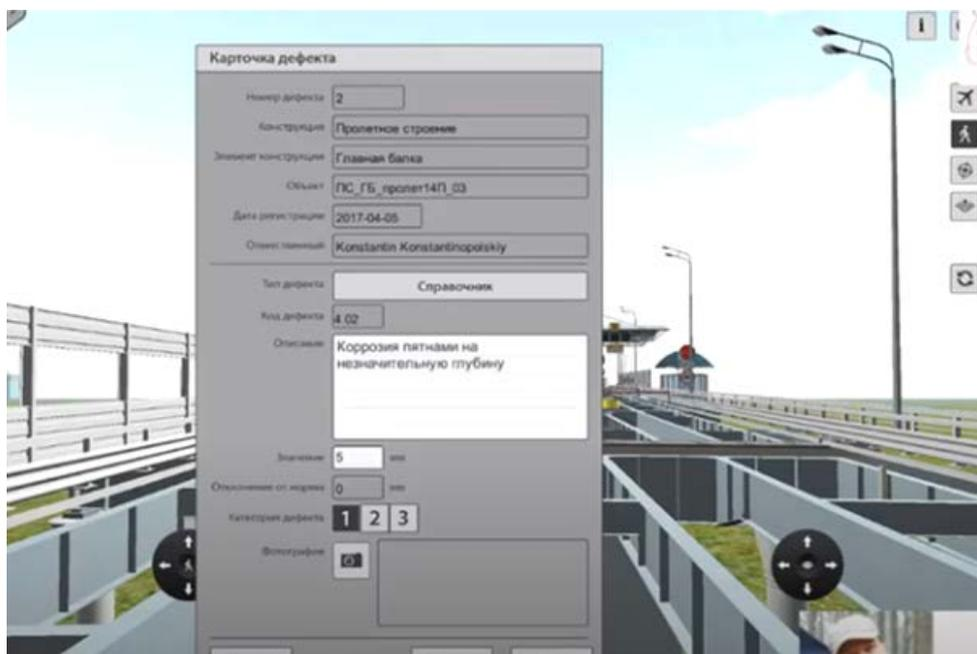
Рис. 2. Описание дефекта в BIM-модели
