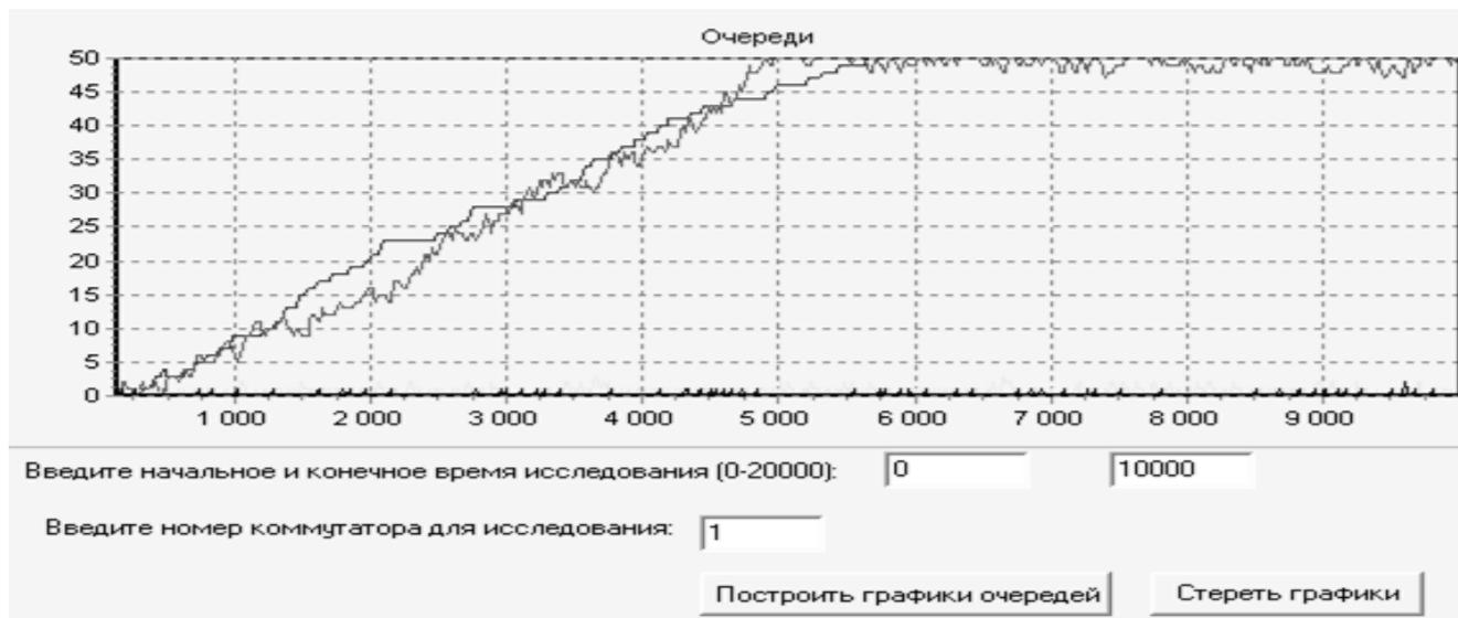
Рис. 2. Результаты моделирования изменения размера буферного накопителя в зависимости от числа тактов на режиме приоритетного обслуживания
