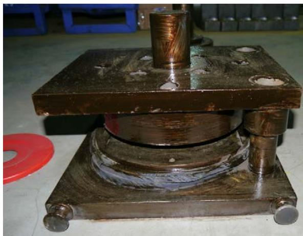
Рис. 8. Фото изготовленного штампа и изделия «Крышка»
