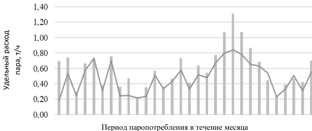
Рис. 1. Диаграмма сопоставления фактических удельных расходов пара (столбцы) на производство бетона, т/ч, с расчетными данными (ломаная линия) по методике [1]
