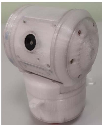
Рис. 1. Общий вид гиростабилизированного опорно-поворотного комплекса технического зрения
