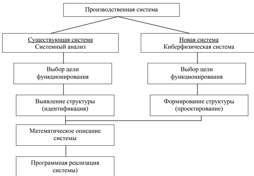
Рис. 1. Технология построения производственных систем
