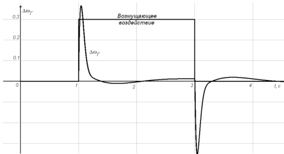
Рис. 7. Переходные процессы в одномашинной регулируемой системе со статической нагрузкой
