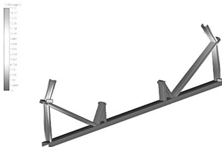
Рис. 9. Стержневая модель основания роlikоопоры с заданными сечениями
