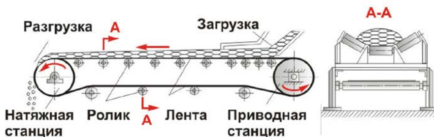
Рис. 1. Схема ленточного конвейера
